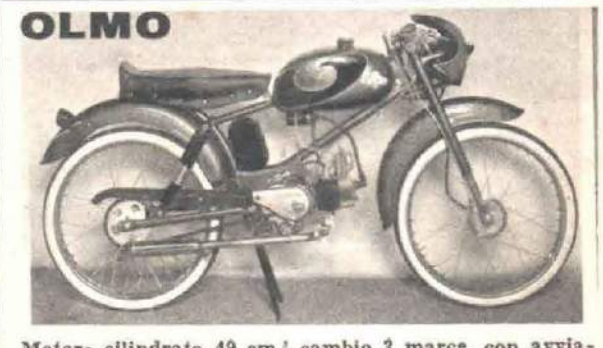
Motorc cilindrata 49 cm. cambio 3 marce, con avviamento da fermo, frizione in bagno olio a dischi multipli
